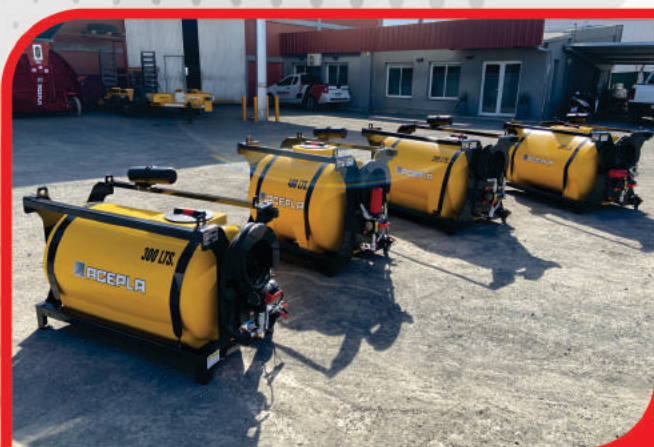
TANQUE PORTÁTIL DE COMBUSTIBLE
